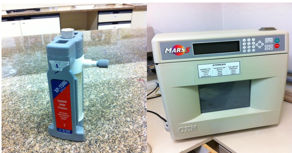
Figura 8 - Vaso de Teflon® (XP-1500) e Micro-ondas CEM-Mars-5 usado na síntese dos nanotubos.
