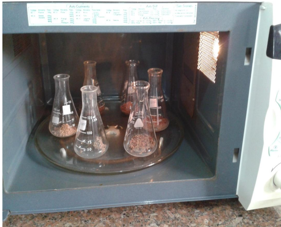
Figura 10 - Amostras de solo no forno micro-ondas para análise do carbono da biomassa microbiana do solo
