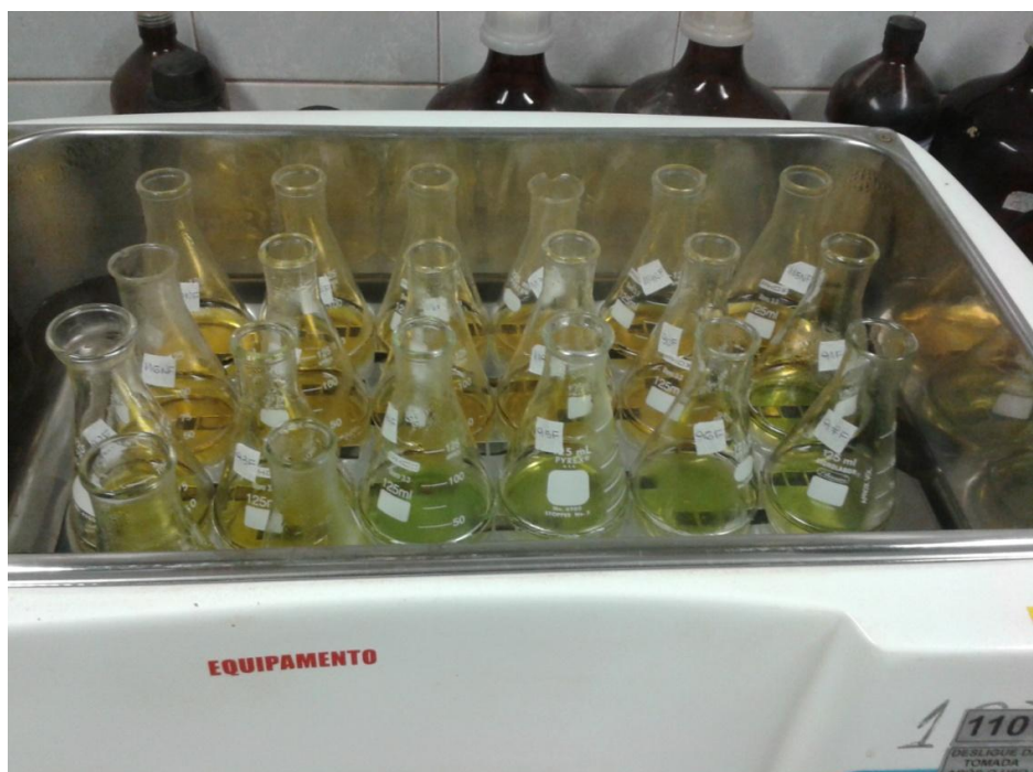
Figura 31: Amostras de solo tratadas ou não por micro-ondas em banho maria para análise da biomassa microbiana do solo
