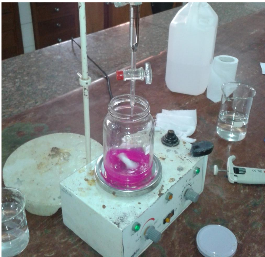
Figura 9 - Ponto final da titulação inicial da solução de NaOH que recebeu o CO 2 produzido pela respiração dos micro-organismos do solo
