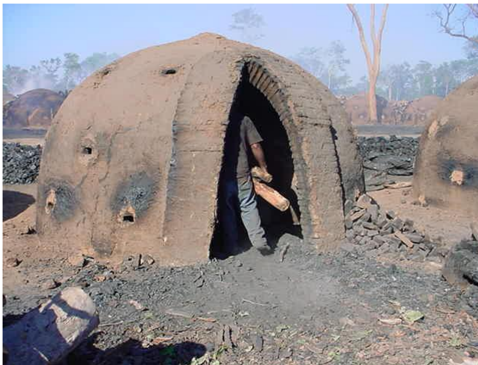
Figura 19 – Forno rabo-quente que pode ser utilizado para a produção de biochar
