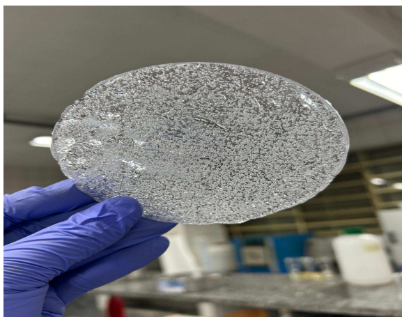
Figura 19 - Policarbonato apresentando aeração
