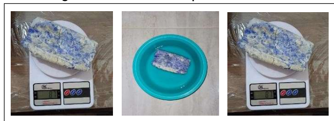
Figura 6 - Teste de impermeabilidade
