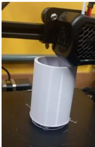
Figura 18 Impressão do filtro (impressora 3D)
