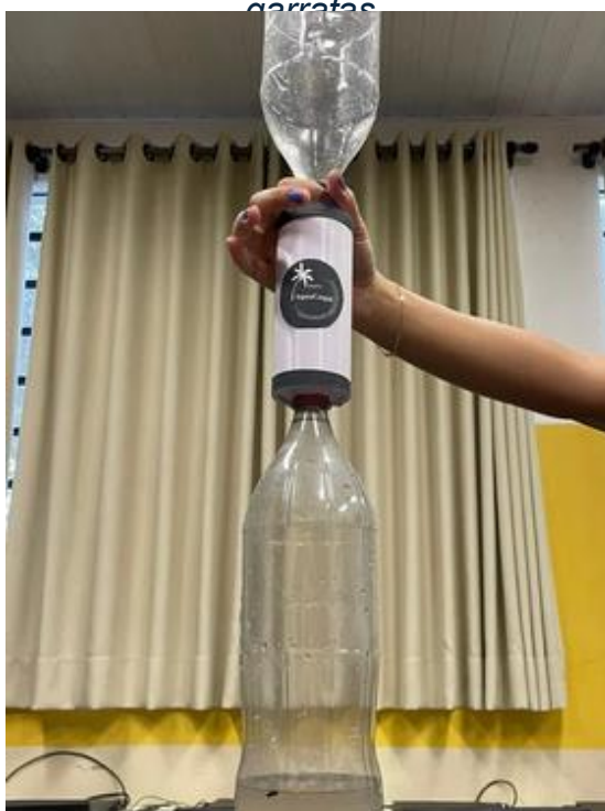
Figura 19 Encaixe do filtro nas garrafas
