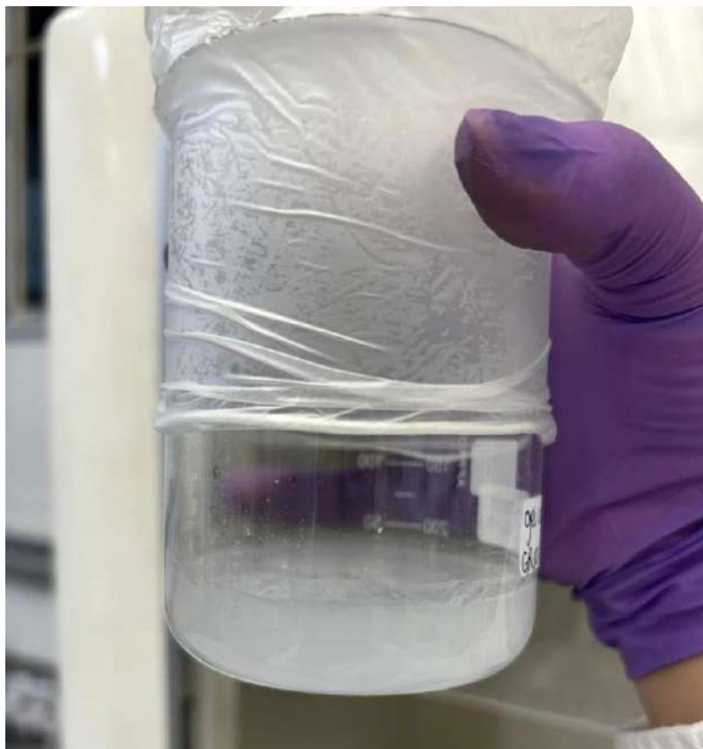
Figura 17- Hidratação de carbopol para confecção de gel
