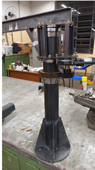
Figura 12: Base e Braço Giratório Montados
