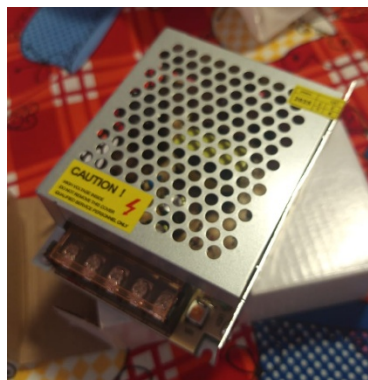
Figura 13: Fonte Chaveada 12V 10A
