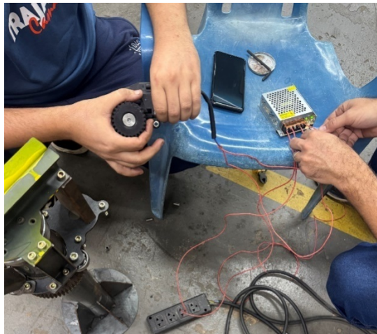
Figura 17: Teste Fonte Acionando o Motor
