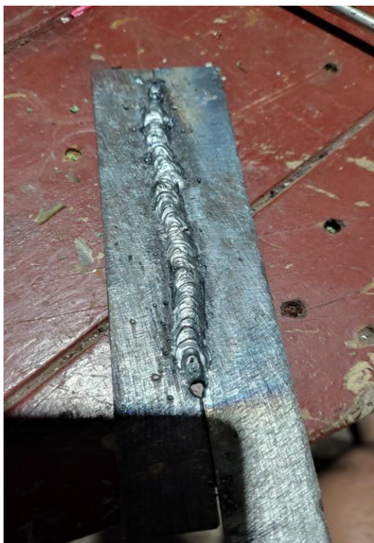
FIGURA 11 – Resultado dos testes: Cordão de Solda feito pela Máquina
