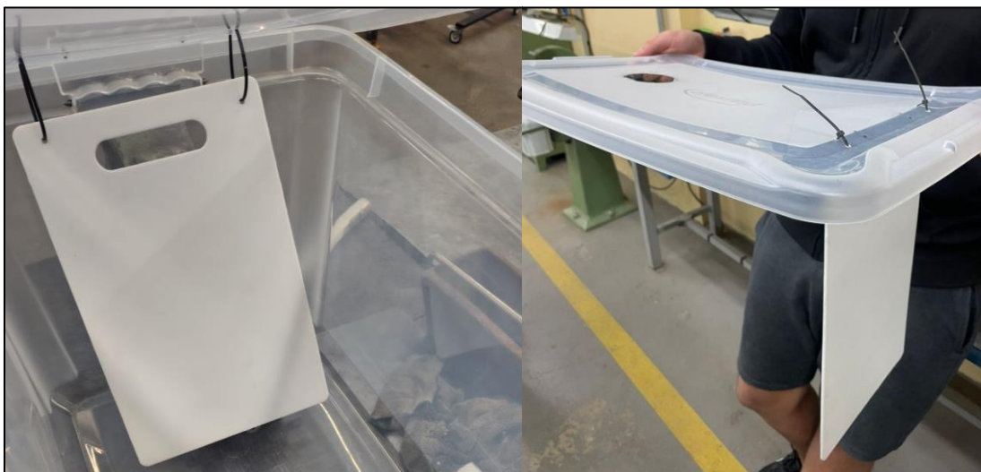
Imagem 16 – Fixação da tábua com abraçadeira
