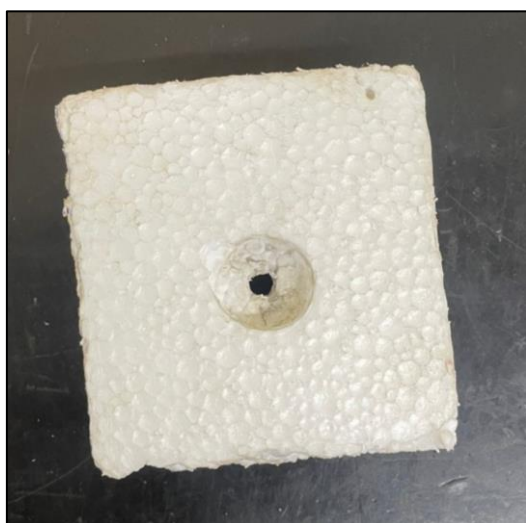
Imagem 14 – Boia furada para fixação no bastão
