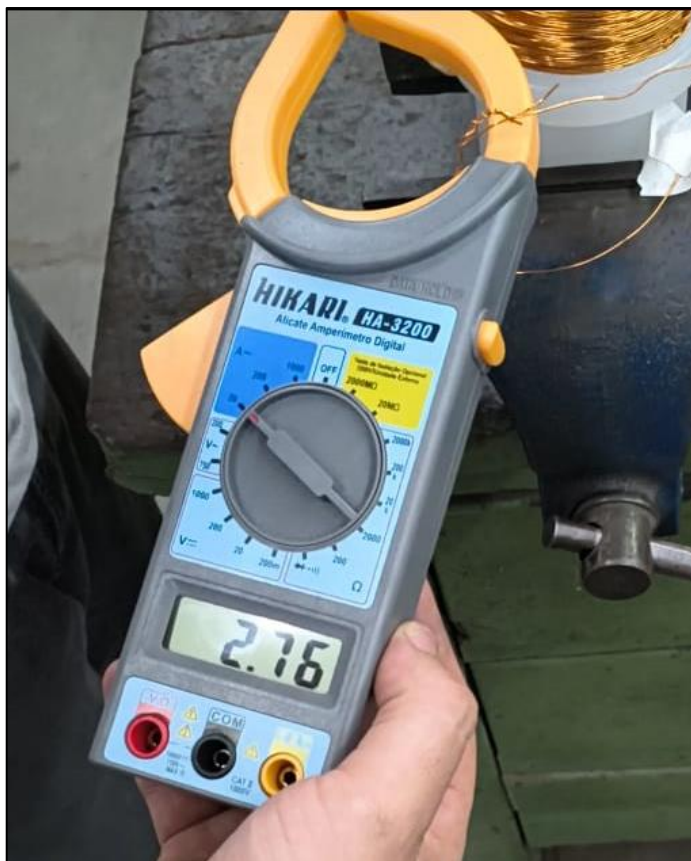
Imagem 25 – Teste da eficiência da bobina
