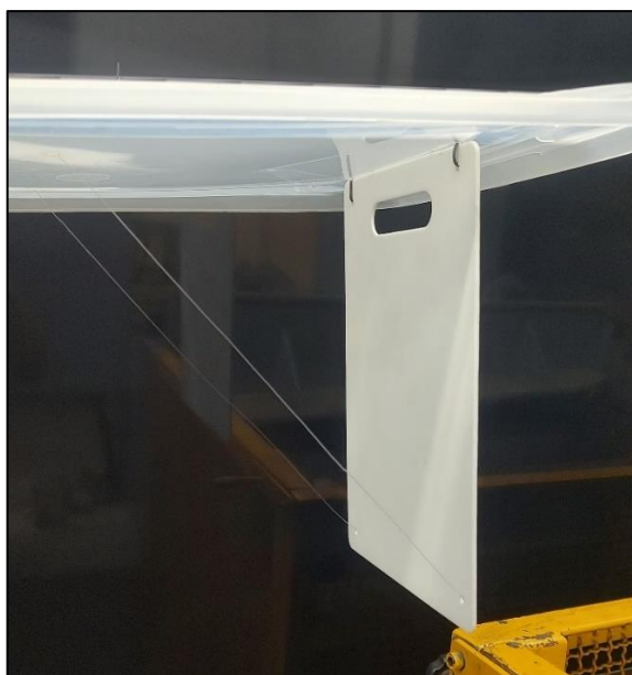
Imagem 17 – Fixação da tábua com linha de pesca
