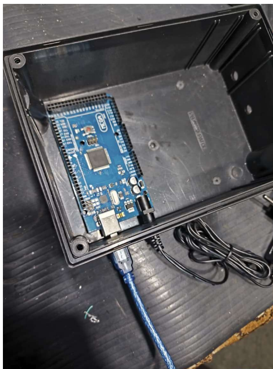
Figura 30 - Posicionamento do Arduino dentro da caixa I
