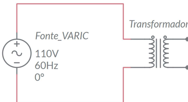
Figura 45 - Esquema elétrico ensaio em circuito aberto (CA)
