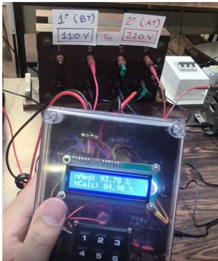
Figura 52 - Resultado do rendimento do transformador ensaiado.
