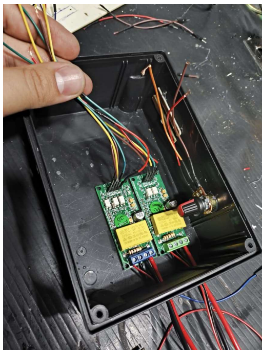
Figura 33 - Posicionamento do potenciômetro dentro da caixa
