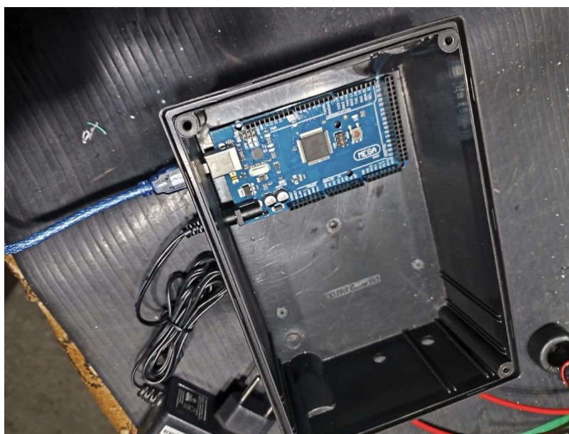
Figura 31 - Posicionamento do Arduino dentro da caixa II
