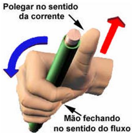
Figura 1 - Determinação do sentido do fluxo do campo magnético em um condutor através da regra da mão direita.
