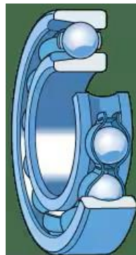
Figura 11- Rolamento rígido de uma carreira de esferas com rasgos de entrada
