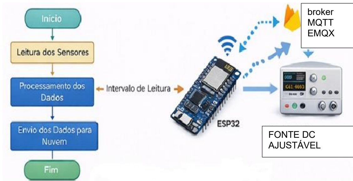
Figura 3: Fluxograma do funcionamento do sistema Wi-Fi com o ESP32.
