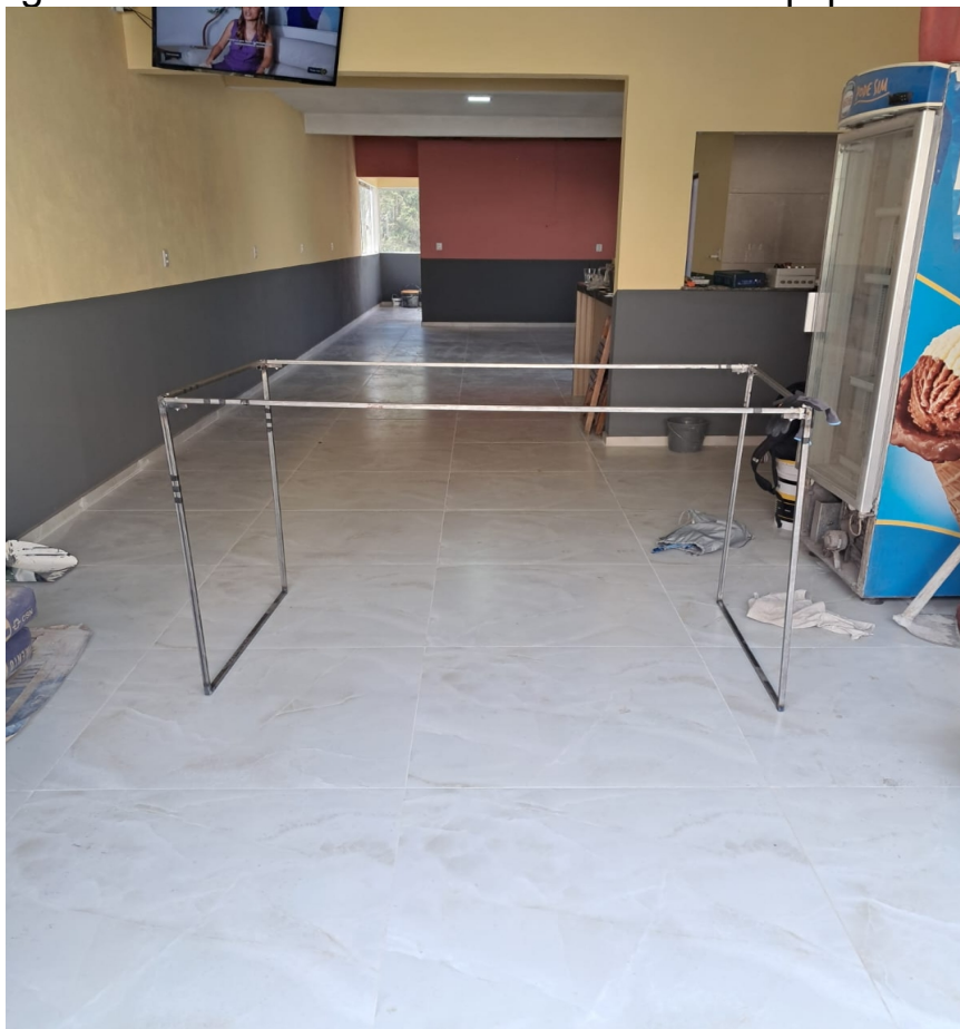
Figura 7 – Estrutura metálica de base do equipamento
