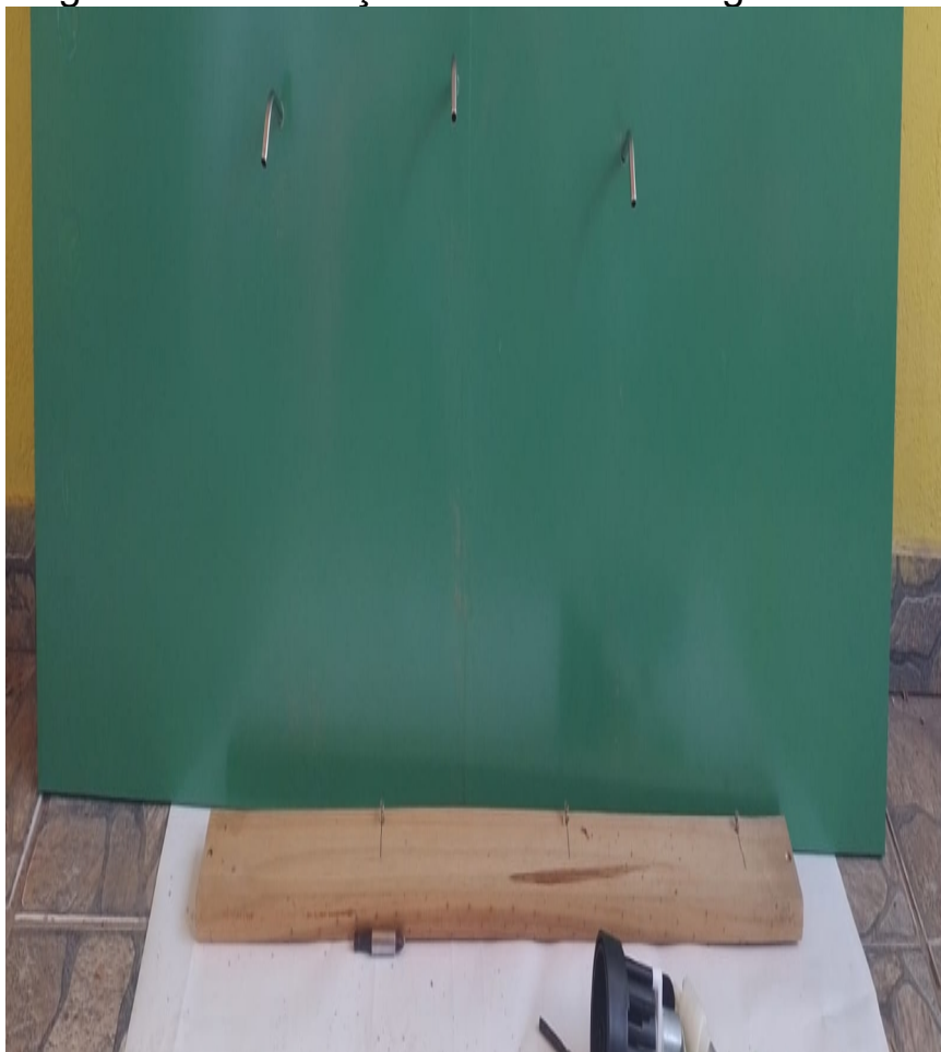
Figura 10 - Instalação das bombas d'água e bicos
