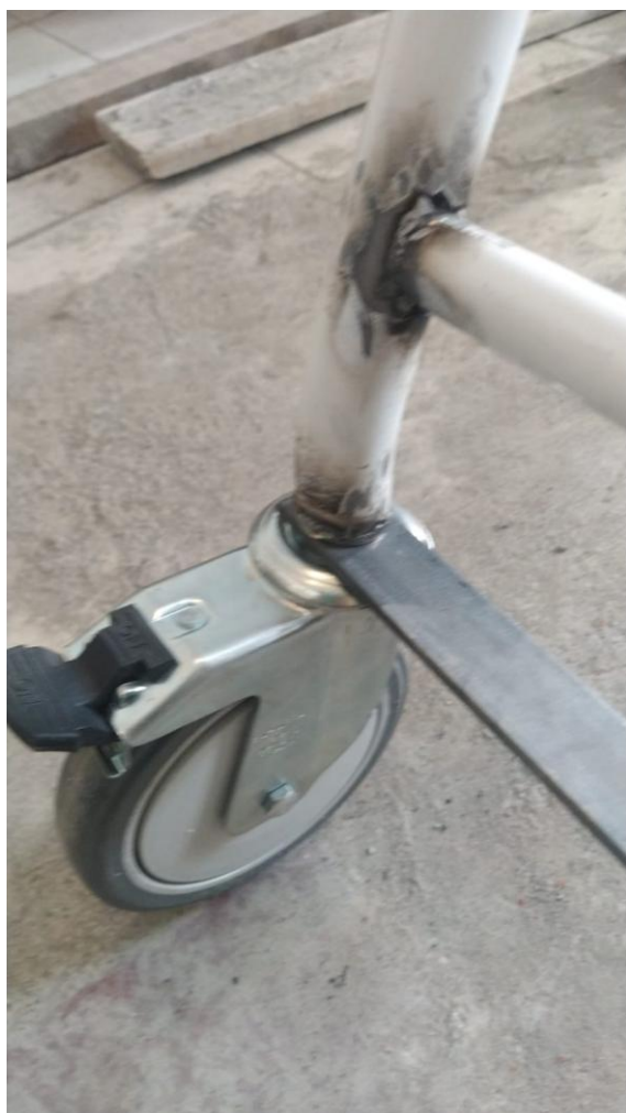
Figura 4: Instalações de Rodízios
