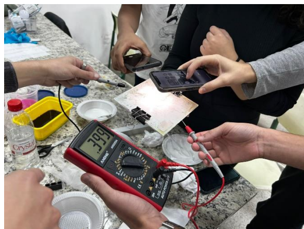
Figura 15– Medição da Voltagem
