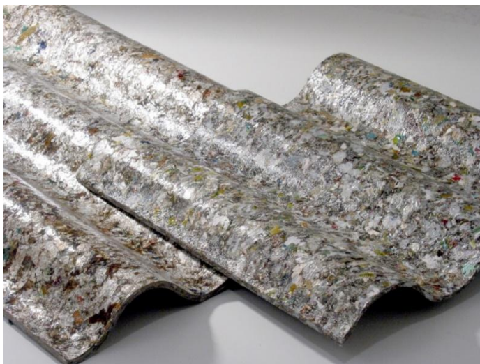
Figura 1 - Telha Tetra pak
