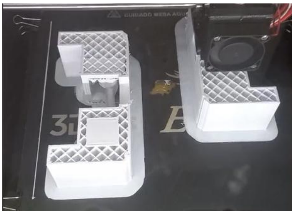
Figura 33 – Processo de impressão do modelo autoral nº5 - Final
