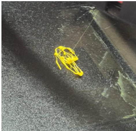
Figura 31 – Filamento não aderido à placa da impressora
