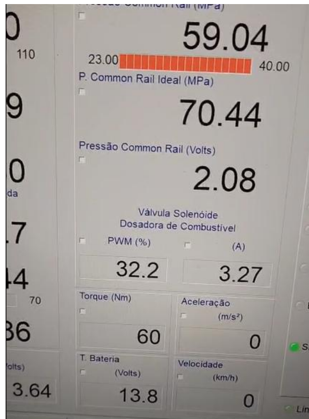
Figura 11: Funcionamento em alta pressão
