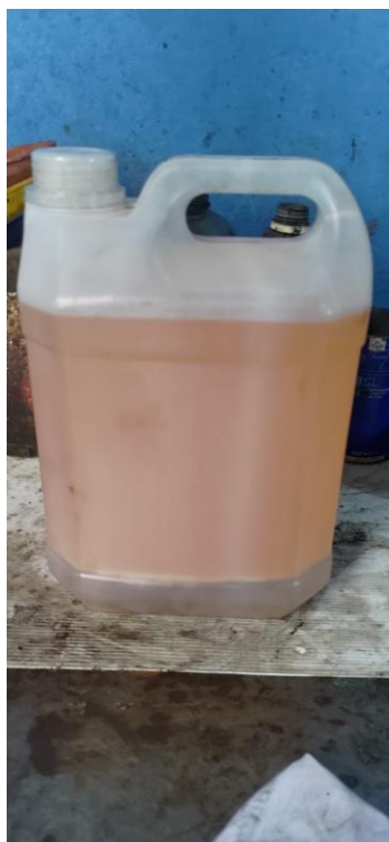
Figura 6: Combustível contaminado com água removido do tanque
