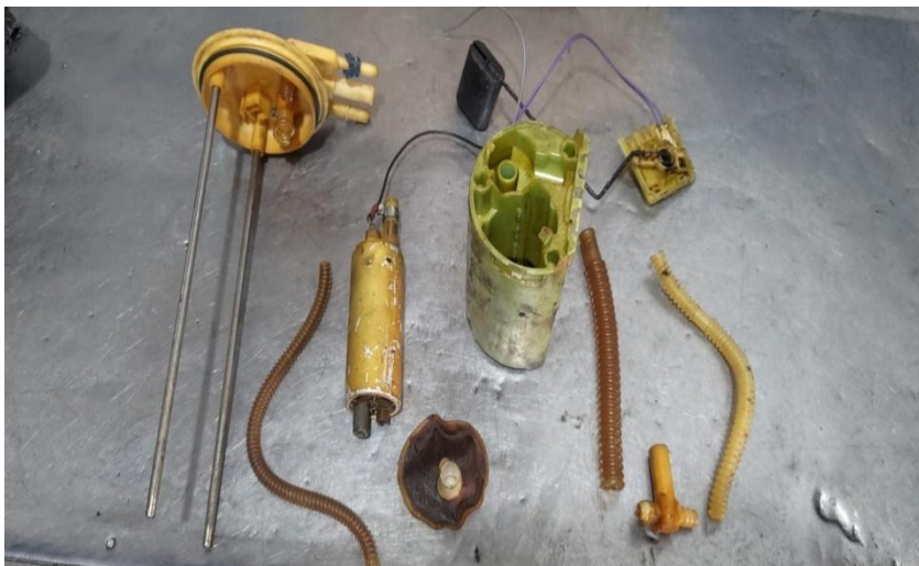
Figura 3: Refil da bomba de combustível completa e desmontada
