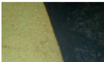
Figura 5: AISI 420 da região externa antes do tratamento de indução, ataque picral 4%
