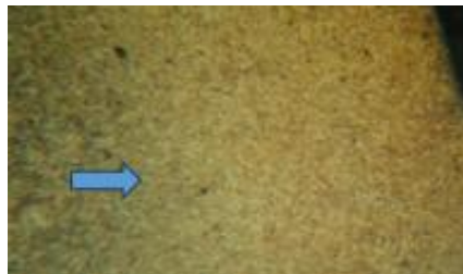
Figura 4: SAE 5115 / DIN 16MN CR5 da camada cementada após o tratamento ataque nital 5%
