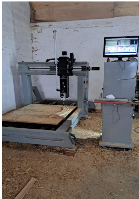
Figura 6: Máquina CNC utilizada na fabricação da caixa de macho
