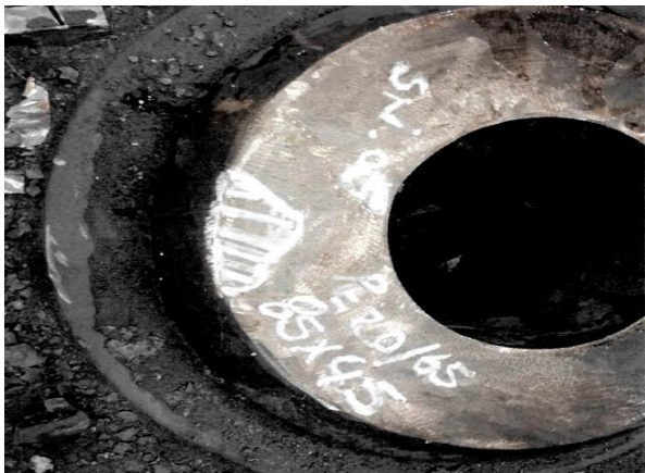
Figura 8: Regiões do rechupe 85x45 mm
