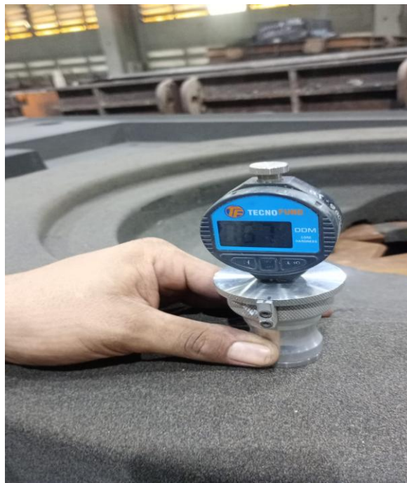
Figura 10: Durômetro constando uma dureza de 67HD
