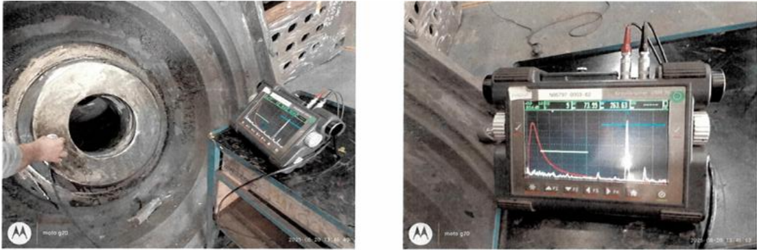
Peça SN 06 – Realizado UT , isenta de indicação de rechupe.
