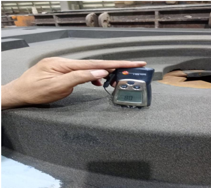
Figura 11: medidor de umidade no especificado 0,8% de umidade
