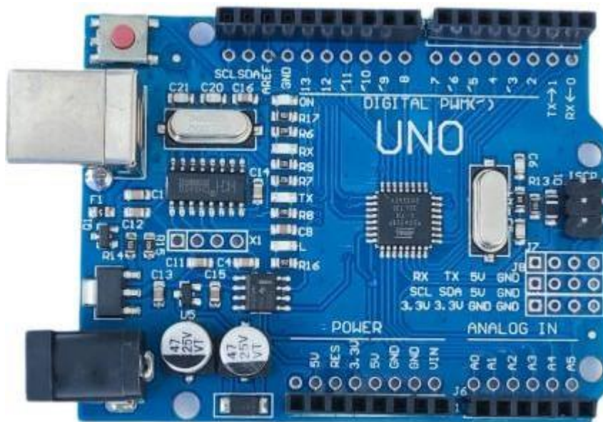
Figura 1 - Arduino Uno R3
