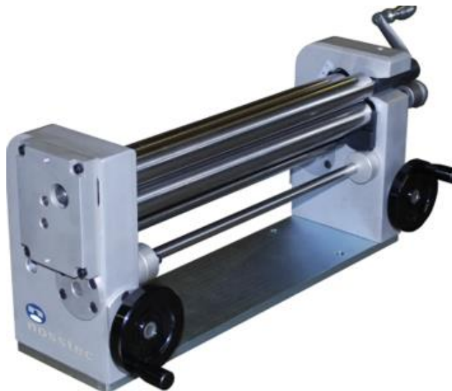
Figura 7 – Calandra manual de 3 rolos Fonte: Direct Industry (2025)
