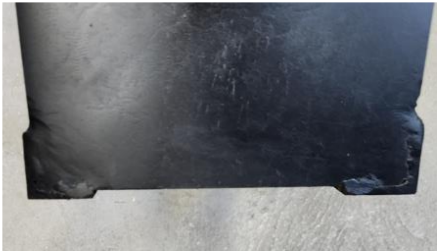
Figura 10 – Soldagem das cantoneiras
