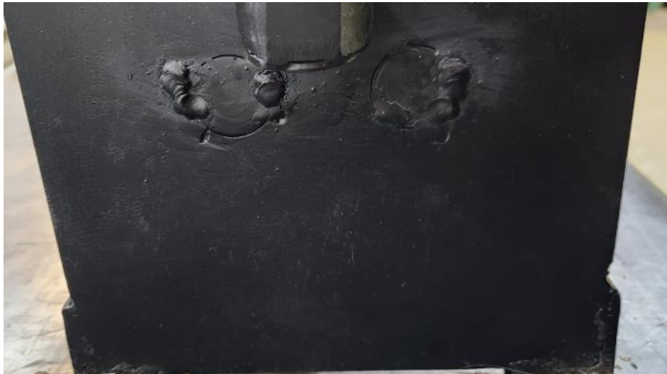
Figura 11 – Soldagem pino lateral
