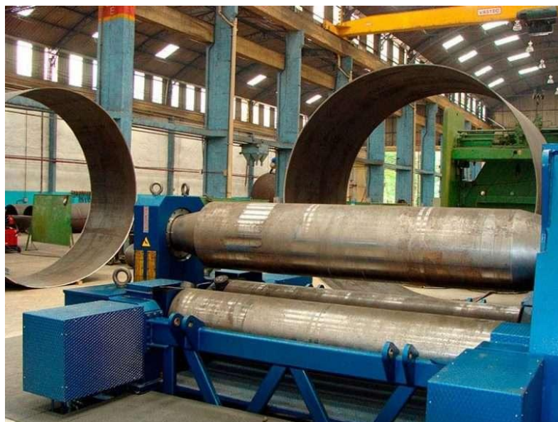
Figura 5 – Calandra automatizada para chapas Fonte: Precismec (2020)
