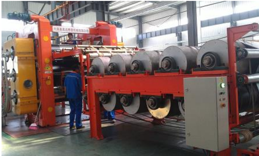
Figura 4 – Calandra automatizada para modelagem de borrachas Fonte: Caetano (2023)
