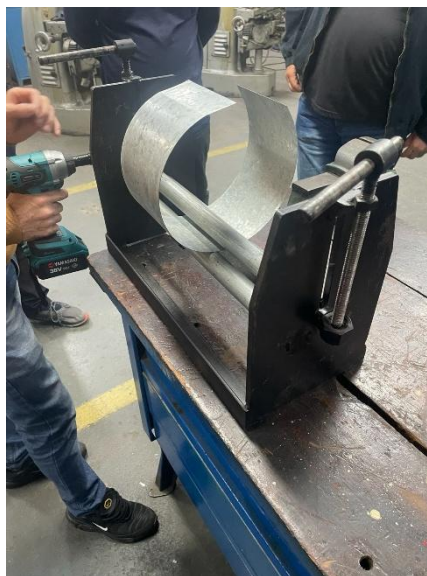
Figura 16 – Calandra em operação
