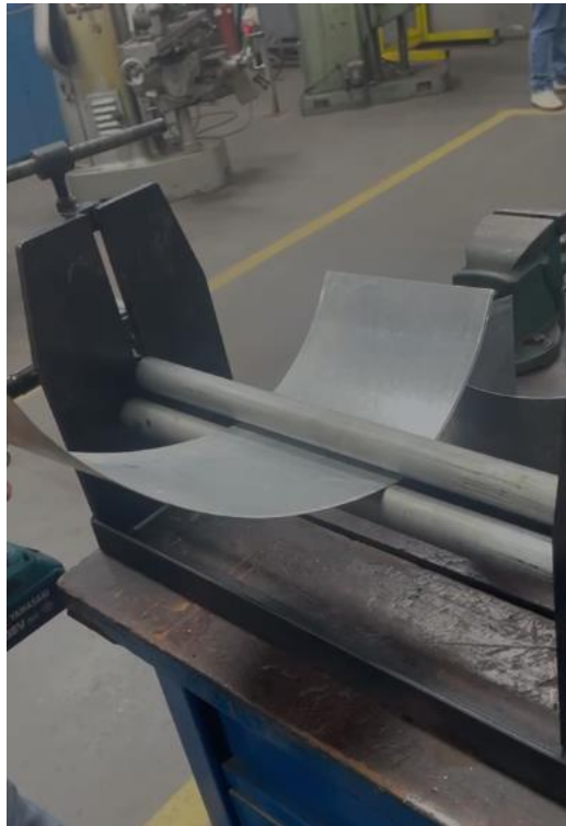
Figura 17 – Calandra em operação
