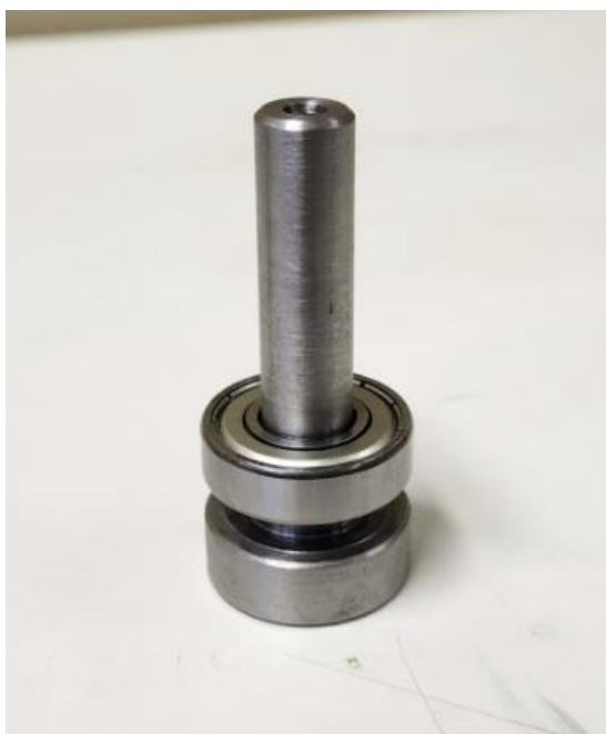
Figura 8 – Montagem rolamento no pino
