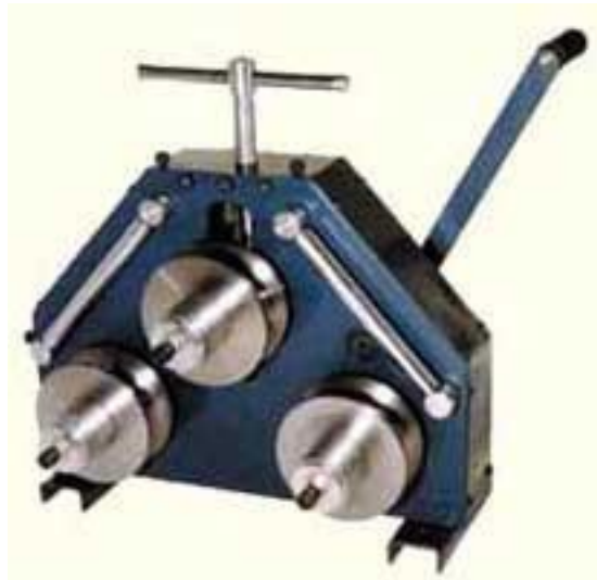
Figura 6 – Calandra manual para tubos Fonte: Holfitech
