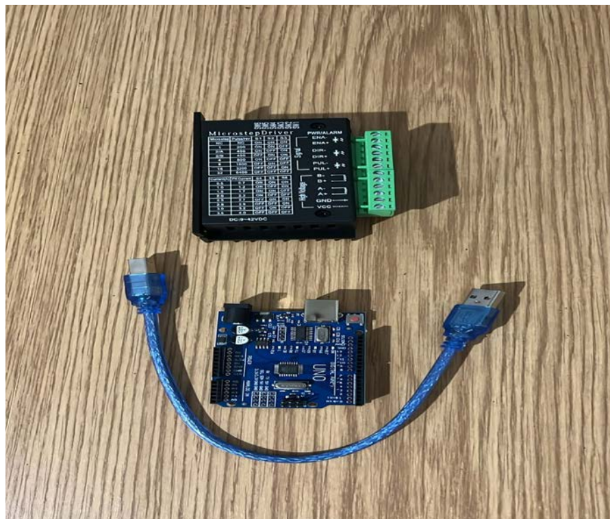
FIGURA 1: TB6600 e Arduino.
