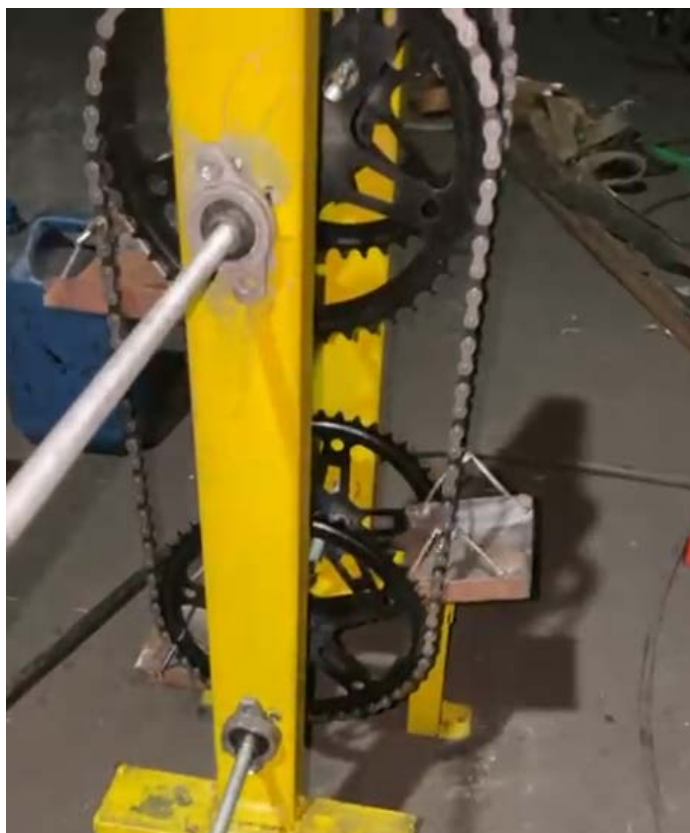
Figura 5. Sistema mecânico do estacionamento com as plataformas móveis
