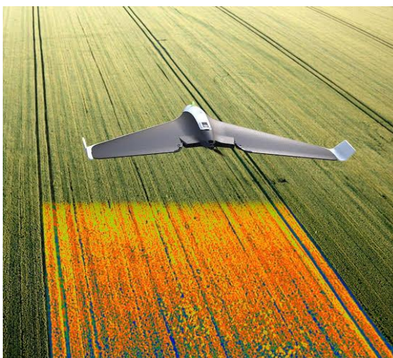
Imagem 1 – Drone asa fixa mapeando uma lavoura.
