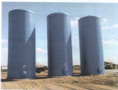
Figura 6: Cisterna de fibra de vidro
