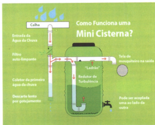
Figura 5: Como funciona uma cisterna
