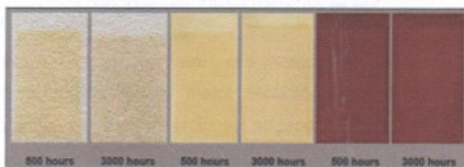
Figura 2 - Exposição QUV - Cinza claro, Beje e Vermelho tijolo – Revista JPCL, Julho 2010
