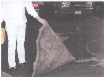
Figura 18 - Aplicação em Concreto sem preparo e sem primer - White Book "Surface Preparation"
