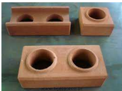
Imagem 10: Tijolo solo cimento
