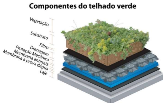
Figura 18: componentes do telhado verde
