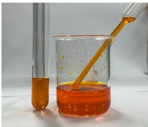
Figura 4: Solução de Dicromato de Potássio em meio Ácido após Reação com Caldo de Cana
