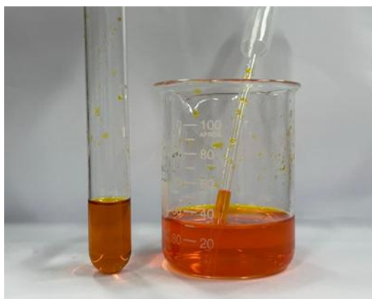
Figura 5: Solução de Dicromato de Potássio em meio Ácido após Reação com Vinagre de Álcool
