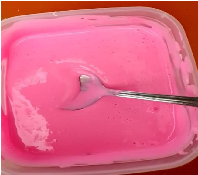
Segundo protótipo que está em fase de desenvolvimento e de testes com 30 ml de cola e 50 gramas do pó fosforescente
