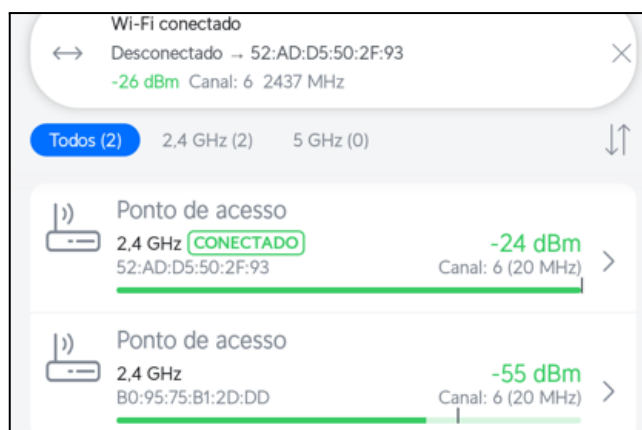
Figura 9 – Cliente conectado no Evil Twin após ataque de desautenticação
