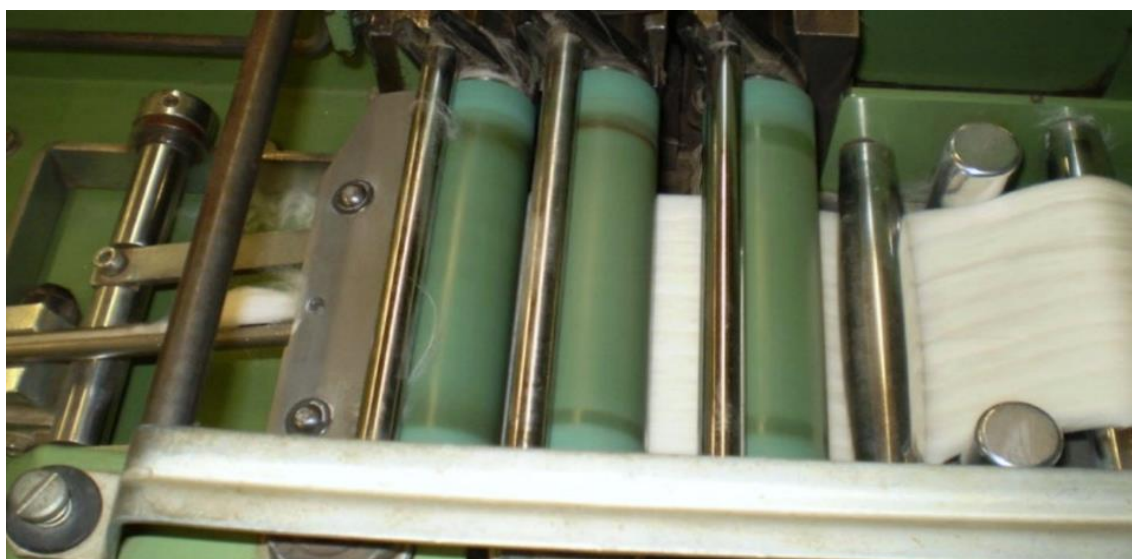
Figura 20 - Trem de estiragem dos passadores
