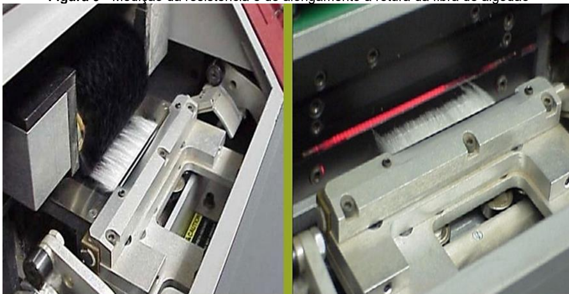
Figura 9 - Medição da resistência e do alongamento á rotura da fibra de algodão
