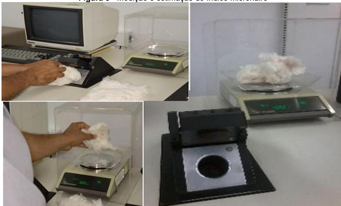
Figura 3 - Medição e estimativa do índice micronaire
