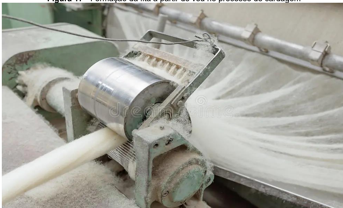
Figura 17 - Formação da fita a partir do véu no processo de cardagem
