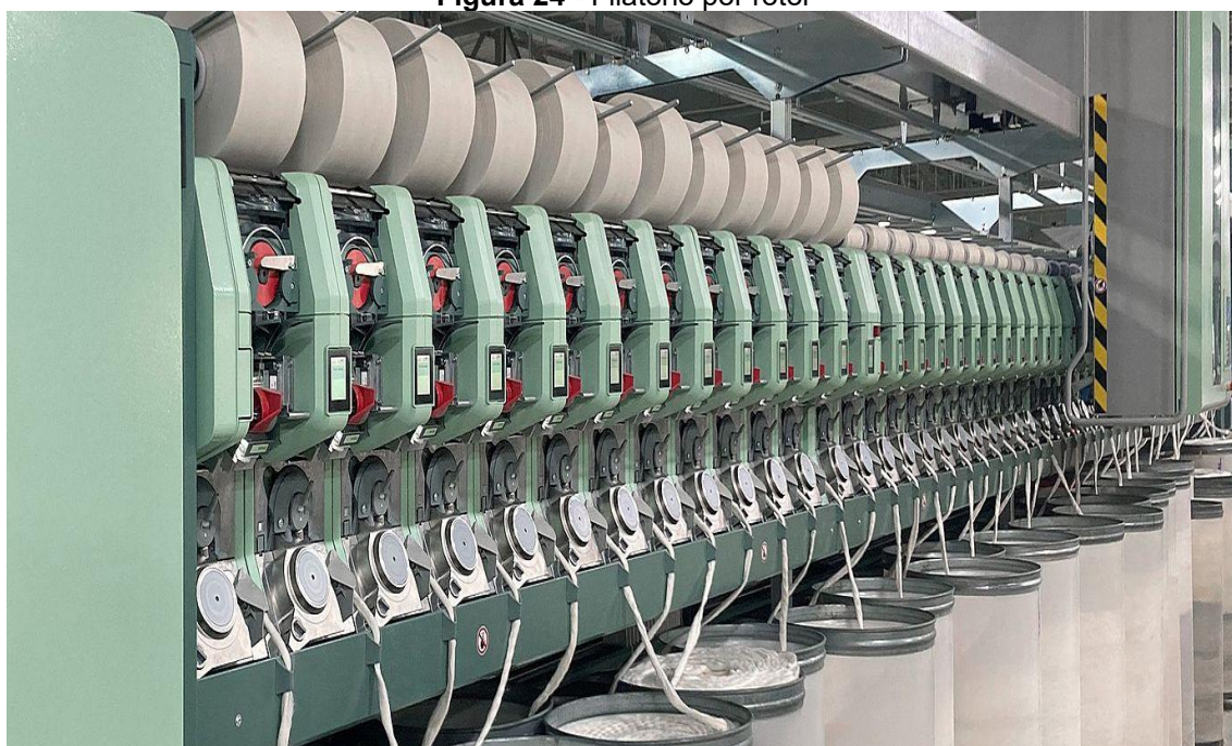
Figura 24 - Filatório por rotor
