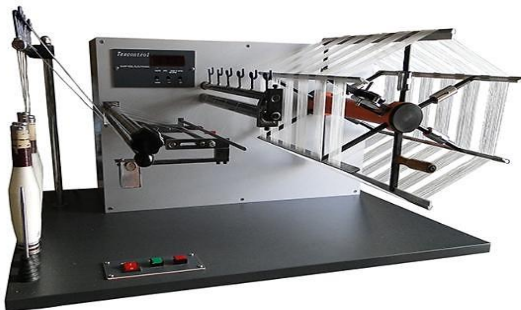
Figura 27 - Aspa para titulação de fibras têxteis
