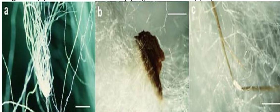
Figura 2 - (a) emaranhamento de fibras (b) fragmento de casca (c) impureza não identificada
