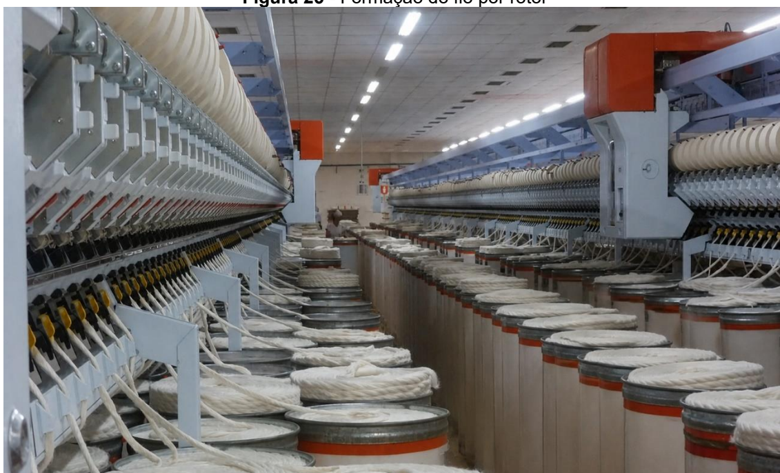
Figura 25 - Formação do fio por rotor
