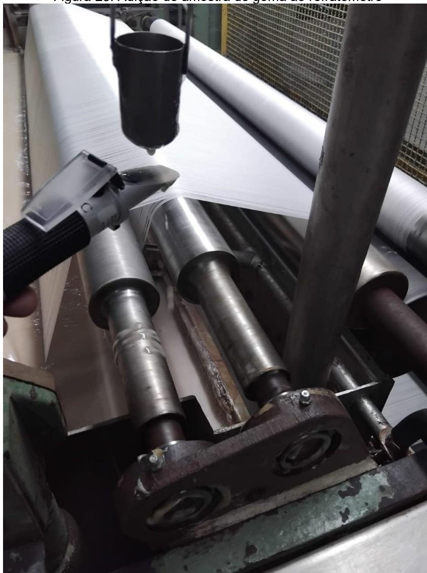
Figura 25: Adição de amostra de goma ao refratômetro
