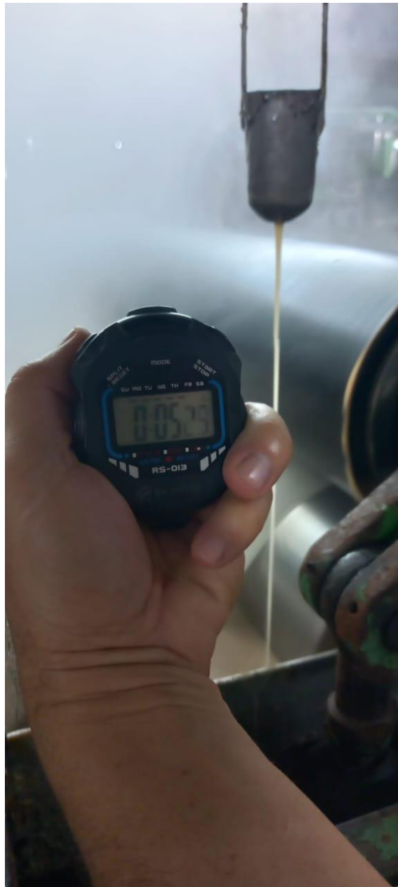
Figura 24: Teste de viscosidade com viscosímetro de orifício
