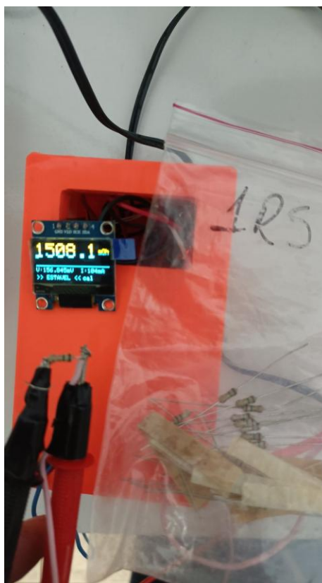
Figura 6 – Display OLED exibindo medição de 1508,1 mΩ com indicador ESTÁVEL
