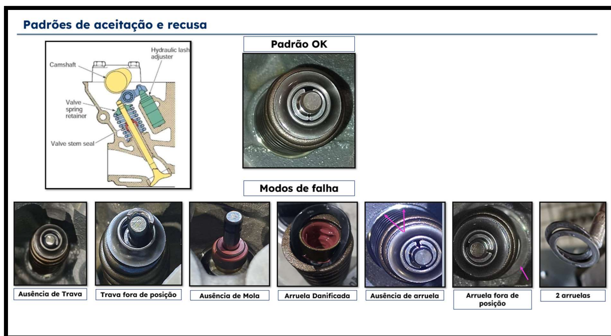
Figura 4: Imagem da montagem de válvula não conforme:
