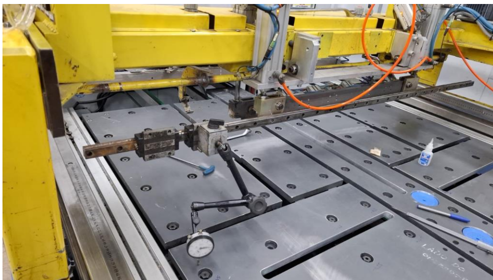
Figura 7: Alinhamento da mesa de pintura
