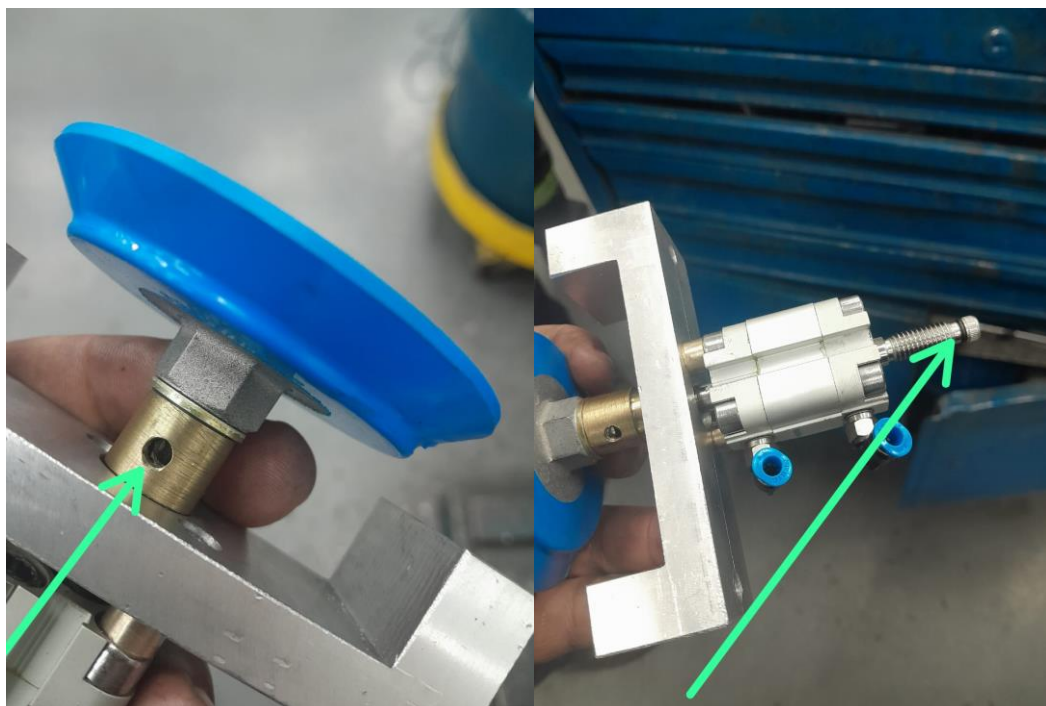
Figura 5: Suportes confeccionados para conexão pneumática
