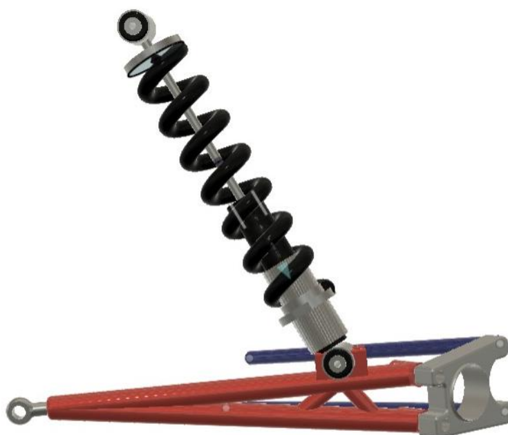
Figura 33 – Geometria final do sistema de suspensão traseira.
