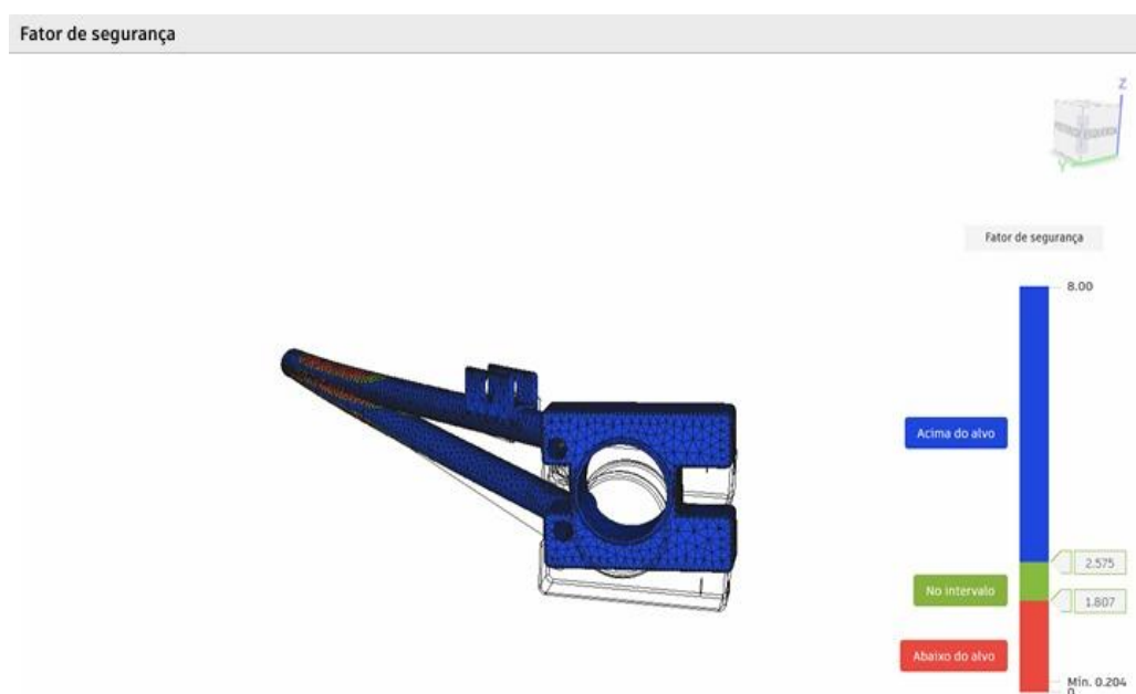
Figura 22 – Fator de Segurança no braço principal na configuração inicial.
