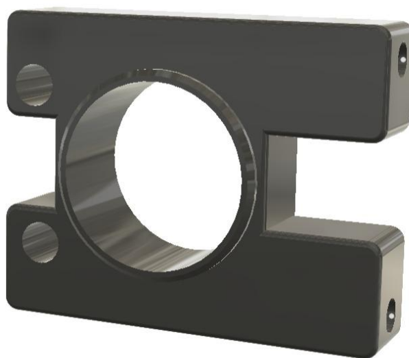
Figura 30 – Geometria inicial manga de eixo.
