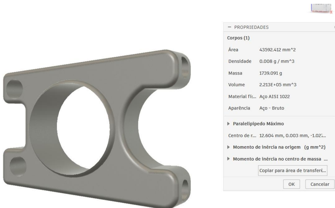
Figura 32 – Malha otimizada manga de eixo.
