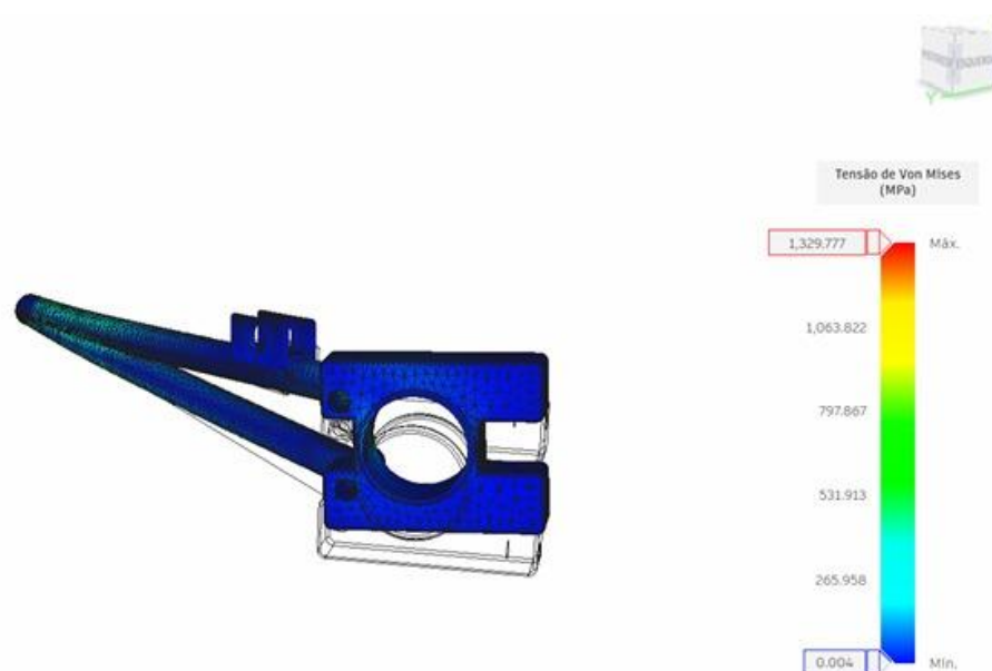
Figura 21 – Distribuição de Tensões na geometria inicial - critério de von-Mises.
