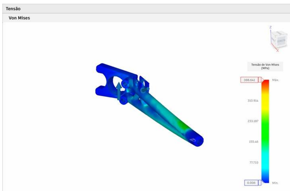
Figura 35 - Resultado de tensão equivalente de Von Mises.
