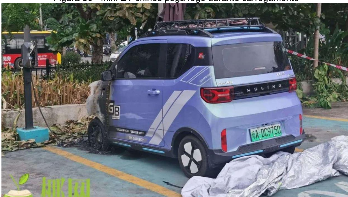
Figura 36 - Mini EV chinês pega fogo durante carregamento
