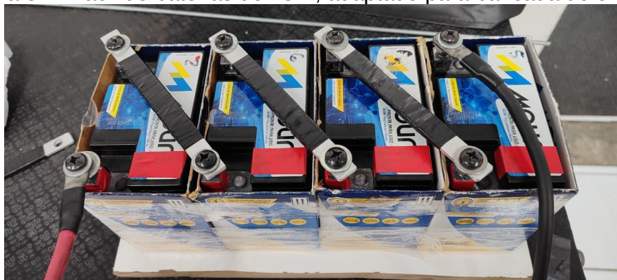
Figura 82 - Pack de baterias de 48 V, adaptado para bancada de ensaios
