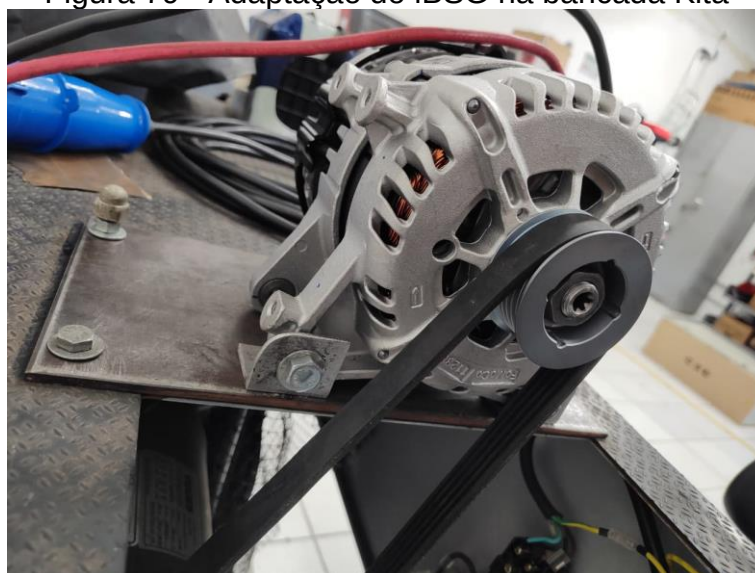
Figura 79 - Adaptação do iBSG na bancada Kita
