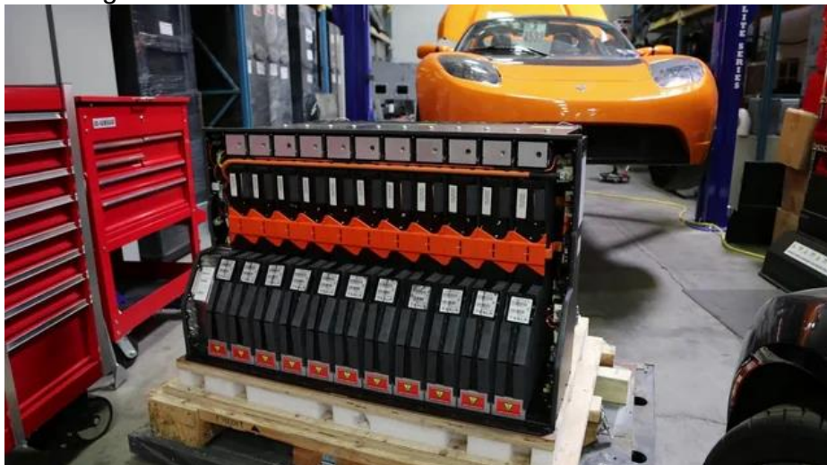
Figura 47 - Pack de Baterias Li-ion do Tesla Roadster
