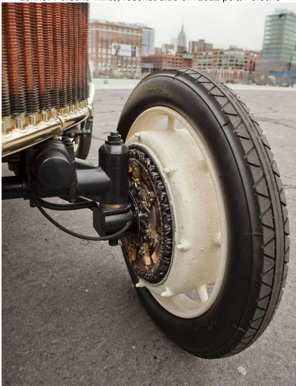
Figura 19 - Motor do tipo Brushless, com cerca de 2,5 CV, usado no modelo do Lohner-Porsche-Mixte, reconstruído em 2011 pela Porsche
