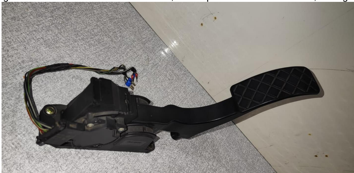
Figura 93 - Acelerador eletrônico Bosch, obtido para otimizar a bancada, vista geral
