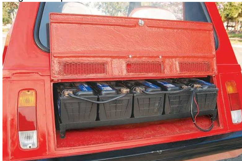
Figura 21 - pack de baterias chumbo-ácido do E150
