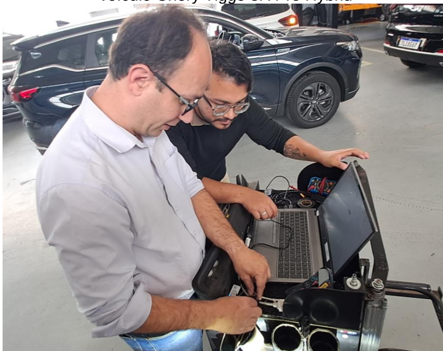
Figura 73 - Configuração de comunicação via rede CAN com módulo do iBSG no veículo Chery Tiggo 5X Pro Hybrid
