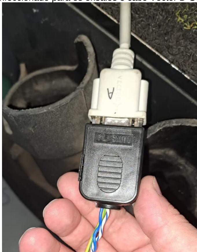
Figura 74 - Hardware de comunicação via CAN com sistema Vector CANape, cabo dedicado confeccionado para os ensaios e cabo Vector D-SUB9 (RS 232)
