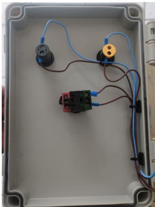
Figura 20 – Conexões dos LEDs e da chave seletora.
