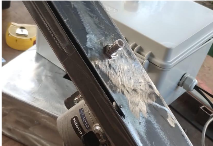
Figura 12 – Sensor superior fixado na rampa de posicionamento.
