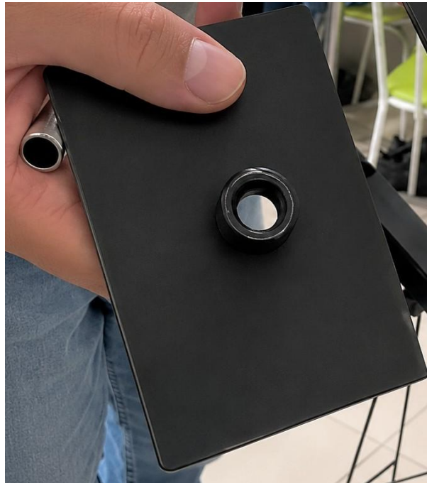
Figura 24 – Peça com a porca soldada.
