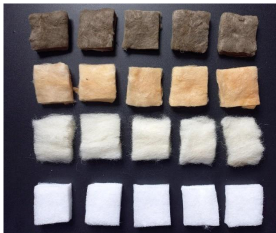
Figura 14 — Corpos de Prova de cada material. Lã de rocha, lã de vidro, lã de ovelha e lã de PET, respectivamente. Fonte: O Autor.
