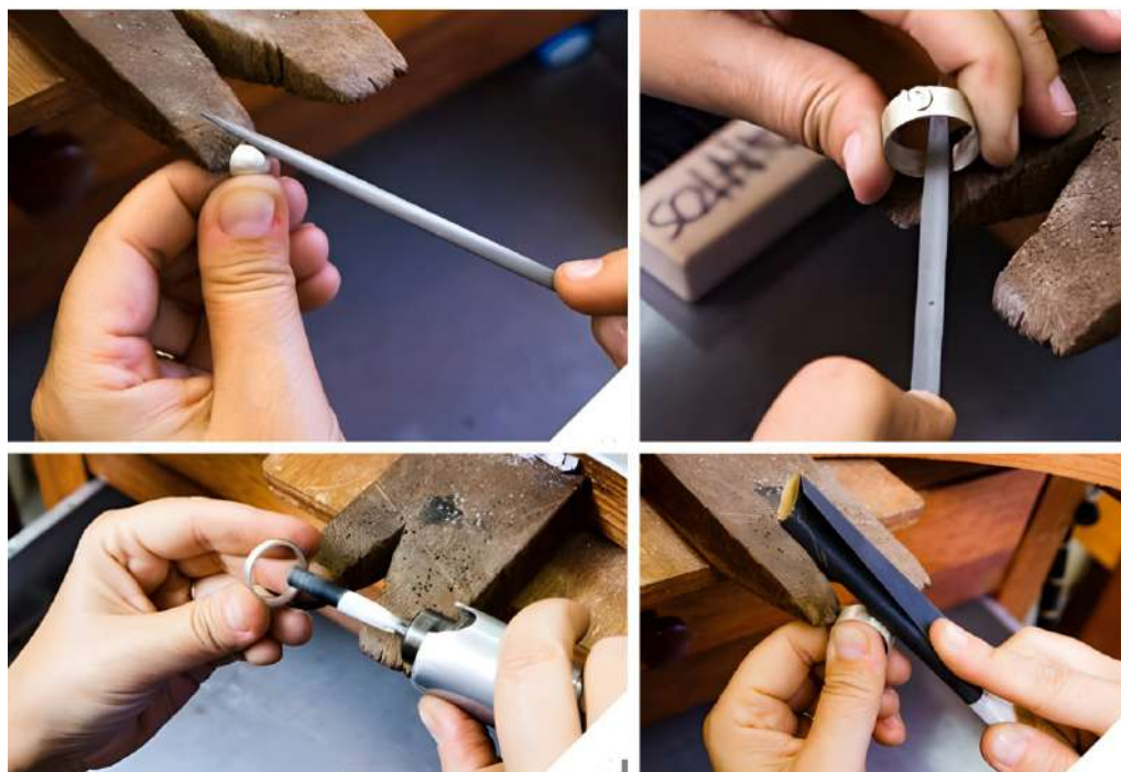
Figura 59 – Processo de acabamento na bancada.
