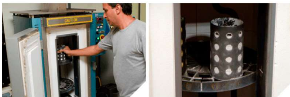
Figura 54 – Aquecimento do tubo de revestimento para evaporar a resina e gerar o molde.
