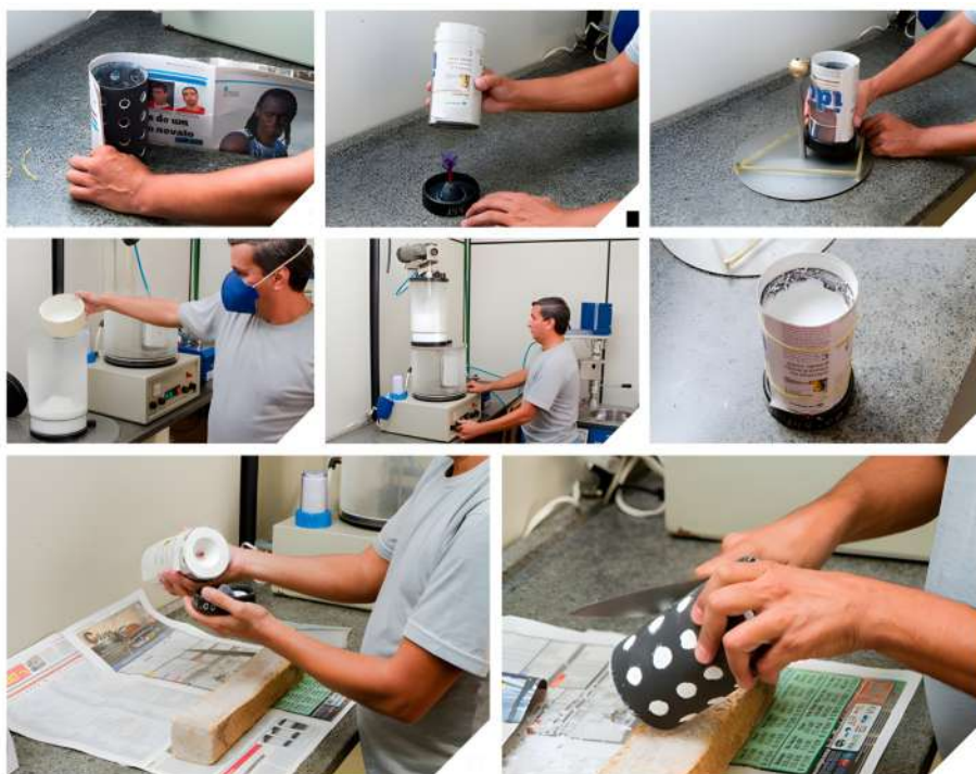
Figura 53 – Processo de criação do tubo com o revestimento para fundição.
