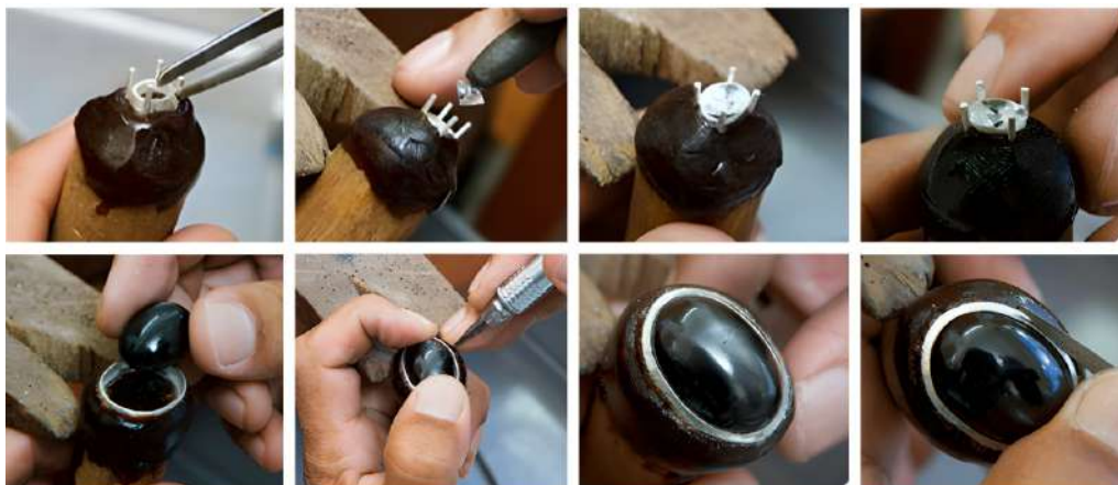
Figura 61 – Exemplo de processo de cravação em garra e inglesa.
