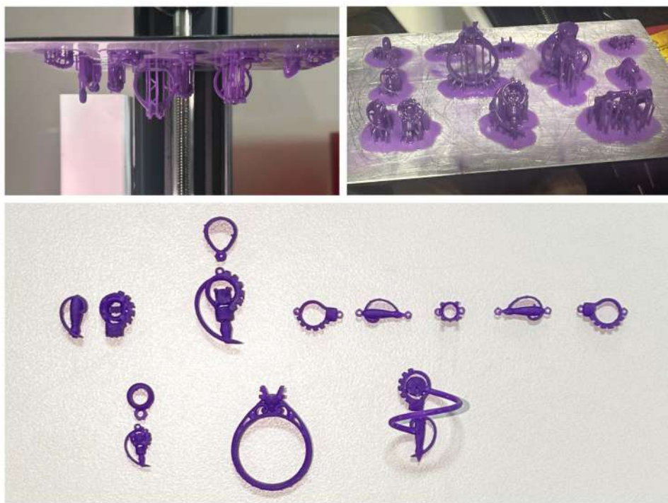
Figura 51 – Processo de impressão 3D em resina calcinável.
