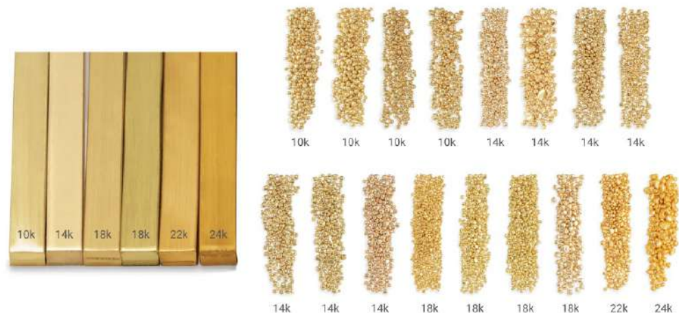
Figura 17 – Diferentes tonalidades de amarelo que o ouro pode adquirir dependendo da mistura de liga metálica utilizada na sua composição.
