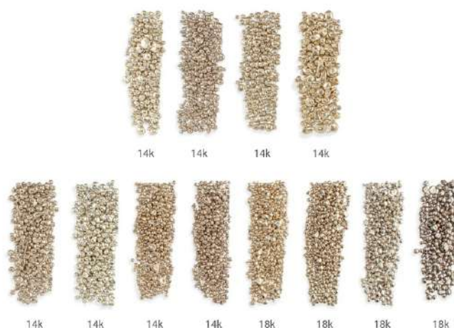
Figura 18 – Diferentes tonalidades de branco que o ouro pode adquirir dependendo da mistura de liga metálica utilizada na sua composição.
