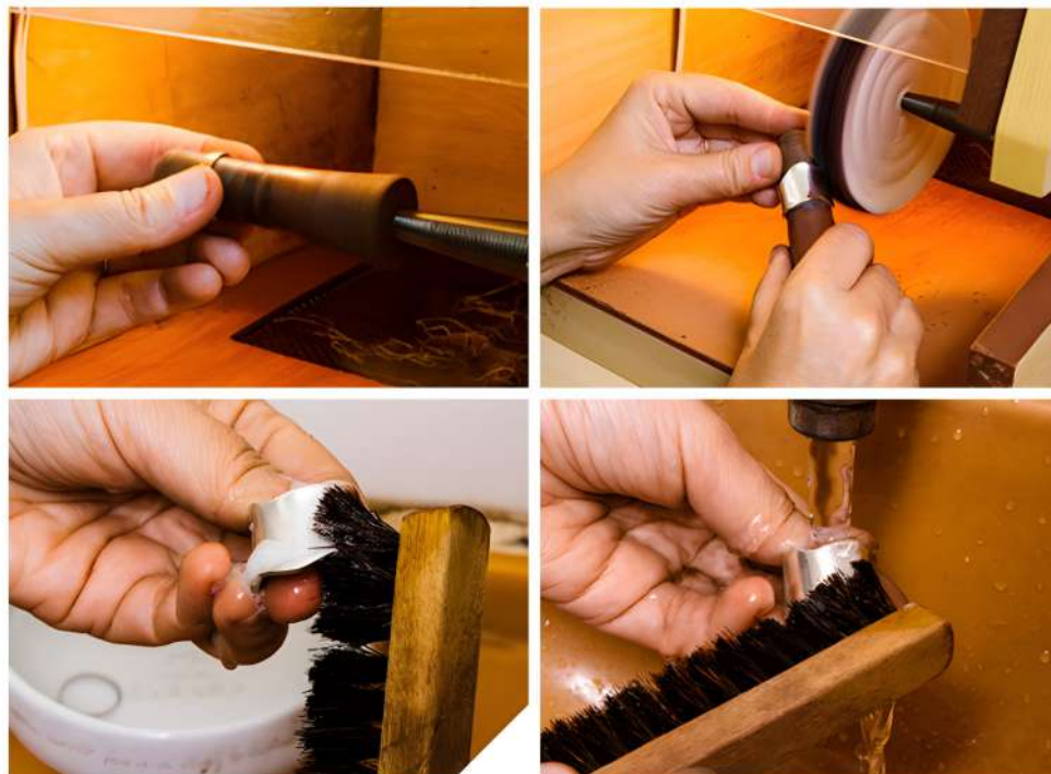
Figura 60 – Processo de polimento e lavagem de uma joia.
