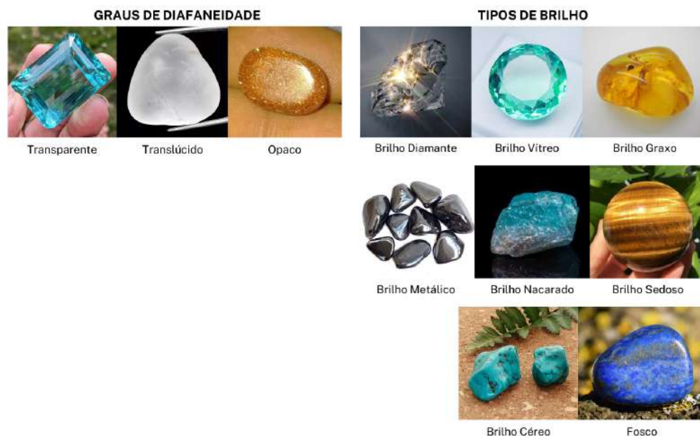
Figura 25 – Exemplos dos diferentes graus de diafaneidade das gemas e os tipos de brilho que elas podem ter.
