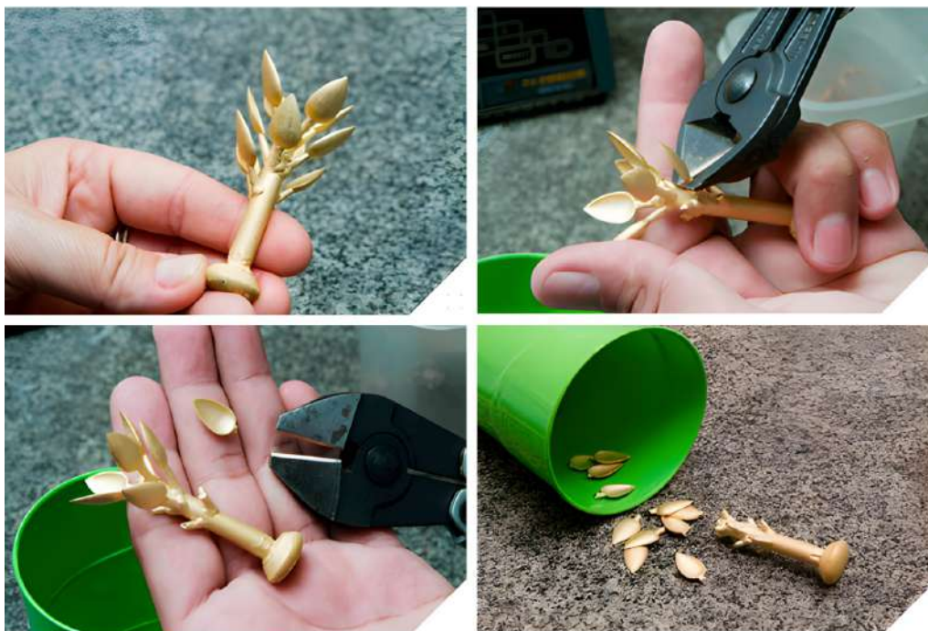
Figura 58 – Peças separadas da árvore com os canais de alimentação.
