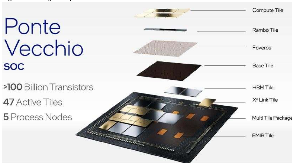
Figura 18 – Organização multi-tile do SoC Ponte Vecchio.
