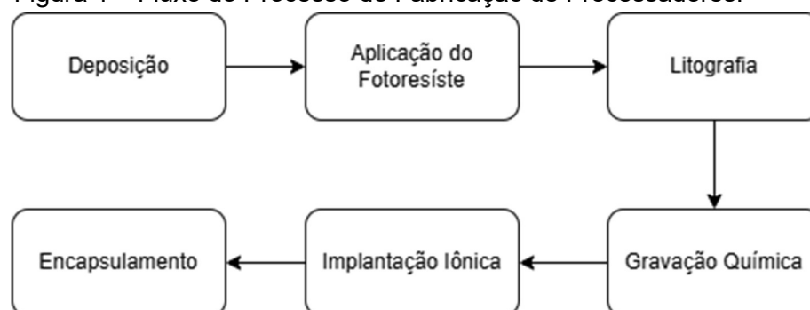
Figura 1 – Fluxo do Processo de Fabricação de Processadores.
