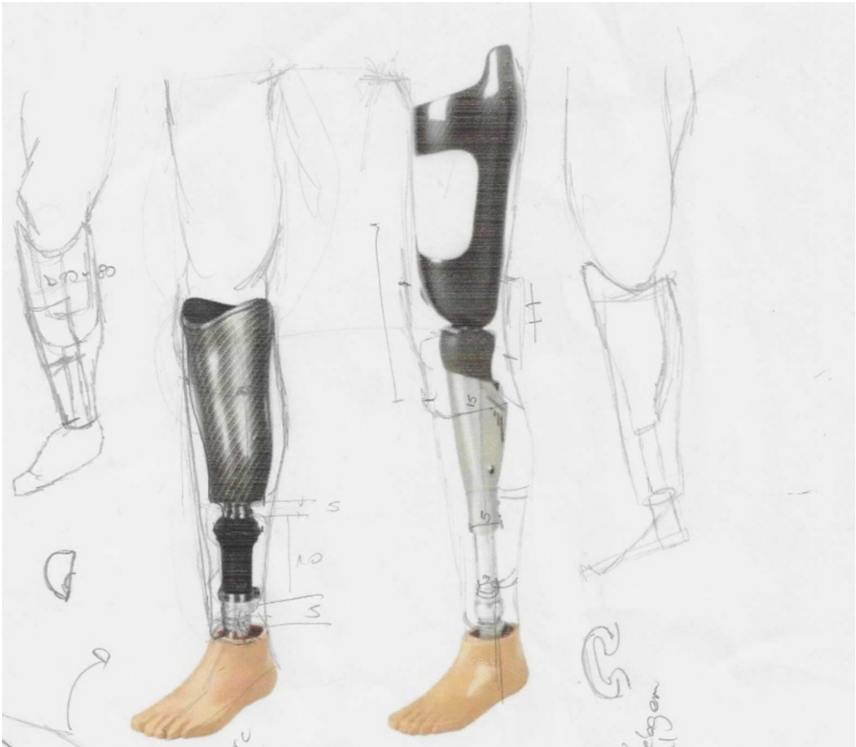
Figura 12 – Esboço da Capa da Prótese Modular
