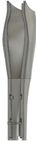
Figura 26 – Visualização dos Encaixes da Parte Posterior da Capa
