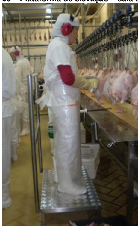
Figura 05 – Plataforma de elevação – sala de corte
