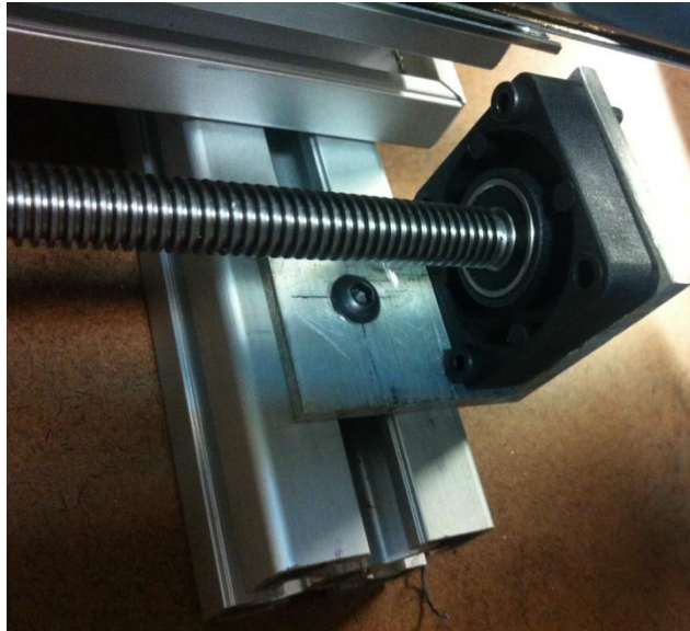
Figura 2.5. Fuso fixado na cantoneira.
