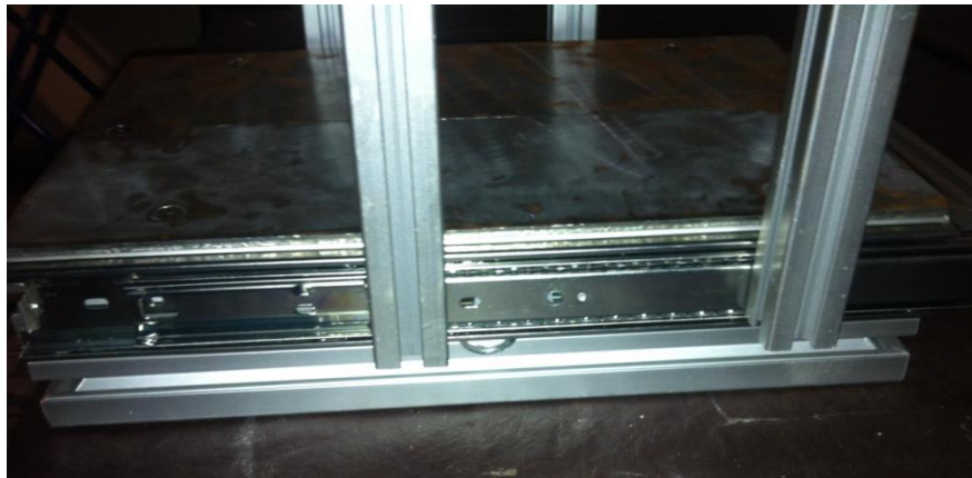
Figura 2.4. Mesa com a corrediça telescópica.
