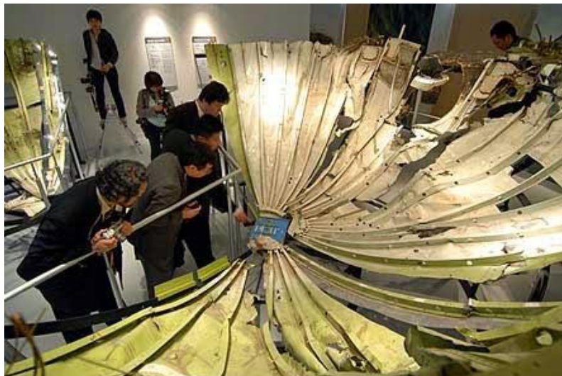
Figura 2 – Fadiga na cauda do JAL 123, levando a queda do avião
