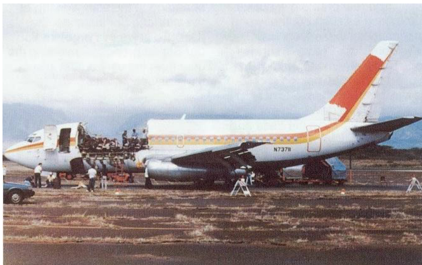
Figura 7 – Fadiga na fuselagem do avião da Aloha.
