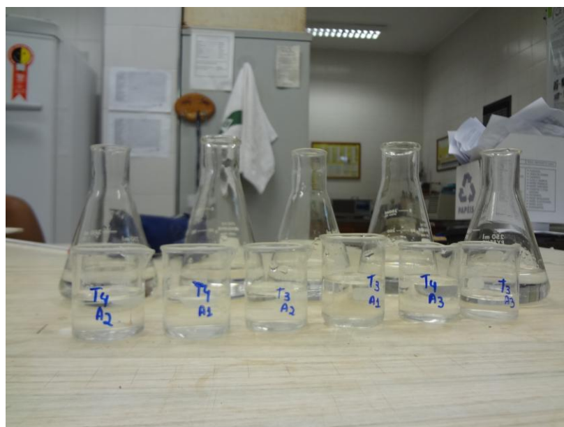
FIGURA 10 – Preparo das amostras para acidez volátil
