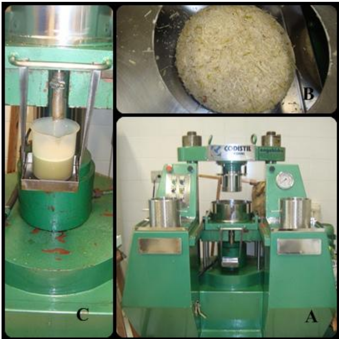
FIGURA 6 - Processo da extração do caldo. A- prensa hidráulica. B- bolo úmido. C- caldo extraído.
