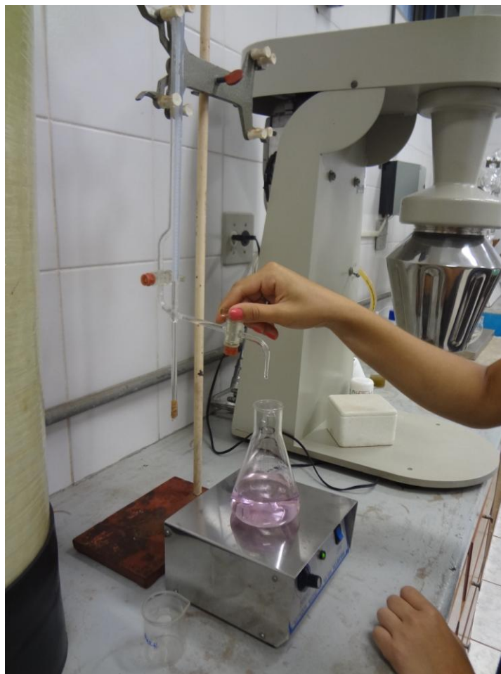
FIGURA 8 - Titulação com NaOH
