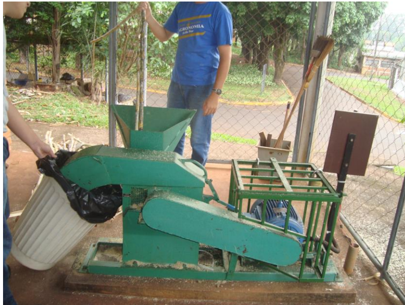
FIGURA 4 - Desfibrador em funcionamento
