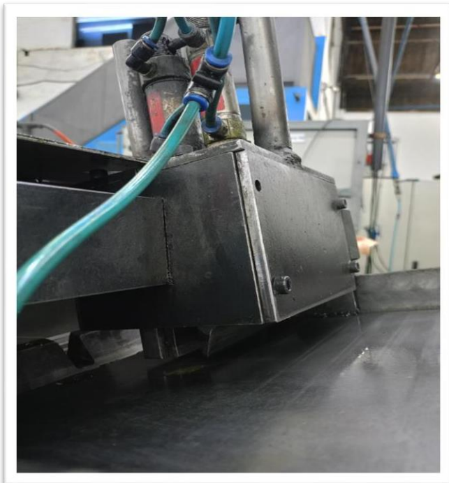
Figura 4 – Trocador para alimentar uma peça por vez
