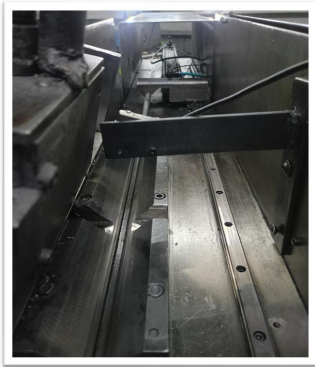
Figura 3 – Prisma para caída da peça e guia linear
